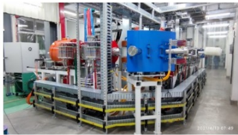
电子回旋共振离子源 (ECR ion source)
